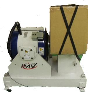
水平方向の振動試験の様子
